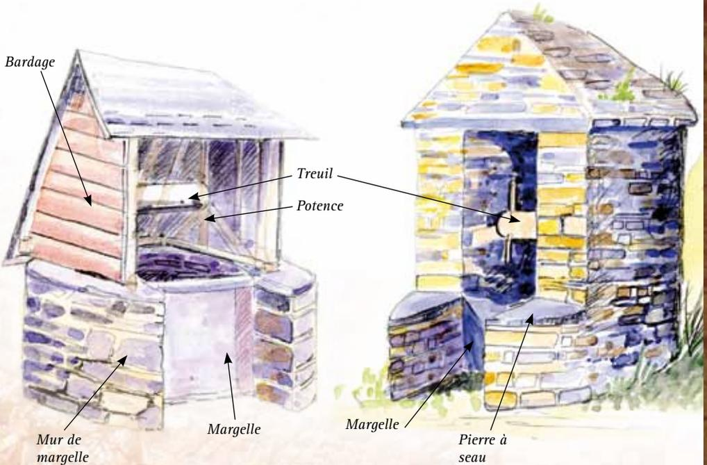
Implanté au dessus d'au minimum un courant d'eau souterrain, il peut être isolé ou construit contre un bâtiment.
